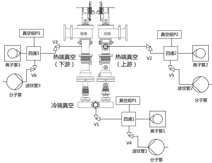
**总体技术目标：**该真空系统能使 1.3GHz 高功率耦合内部真空度达到  $10^{-6}$ Pa 量级；各处接口漏率要求为  $1 \times 10^{-11} \text{Pa} \cdot \text{m}^3/\text{s}$ ；所有真空管道、真空阀门都须经严格的检漏及清洗除气，保证无污染。
